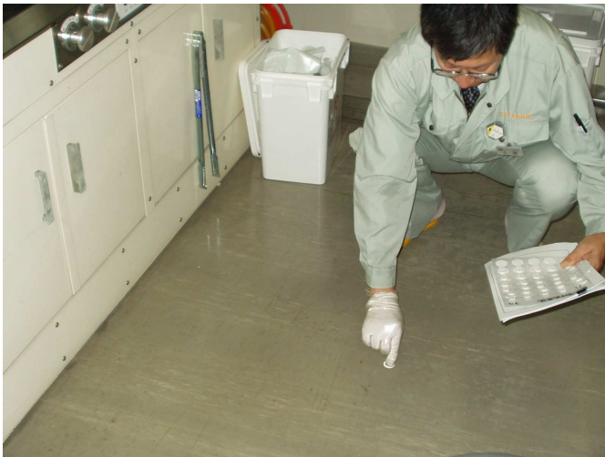
◇ RI 表面汚染測定（スミア法）
