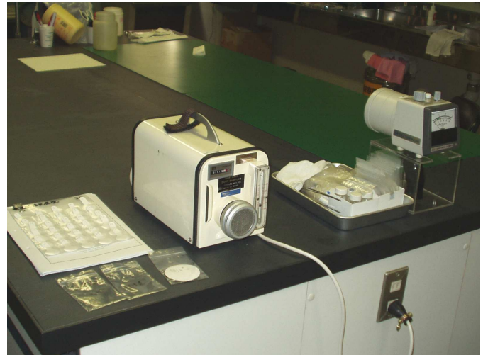
◇ RI 空气中濃度測定（エアースAMPLING）
